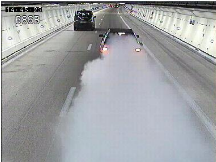
Dégagement de fumée (casse turbo)
