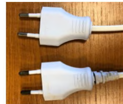
Figuur 5: de twee stekkers, boven de verouderde en daaronder de nieuwe en schone stekker
